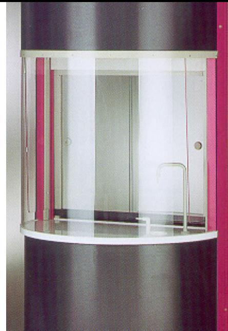
**Senkrecht verschiebbare Frontschieber müssen stufenlos verstellbar sein, in jeder Lage gehalten werden und gegen Herabfallen gesichert sein**
